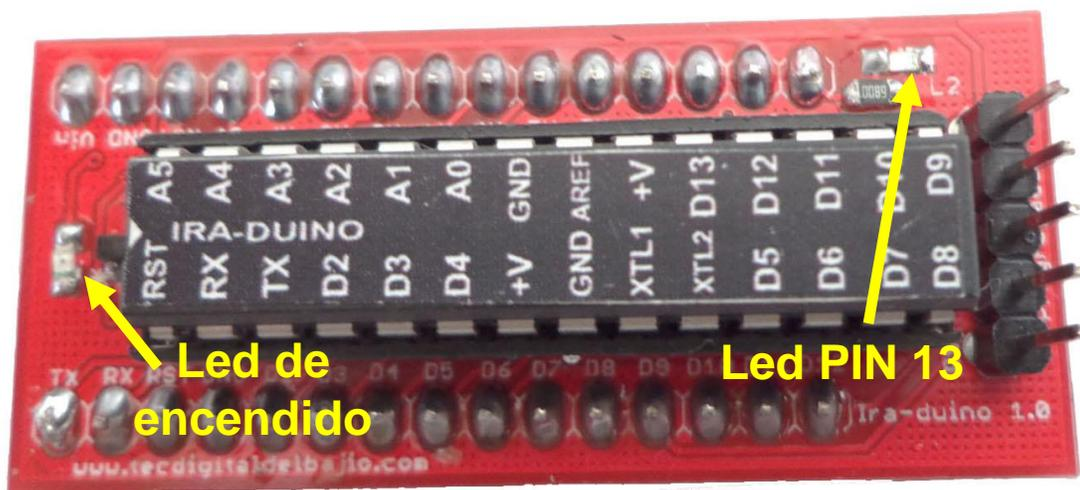
Figura 2.3 LEDs indicadores del programador USB
