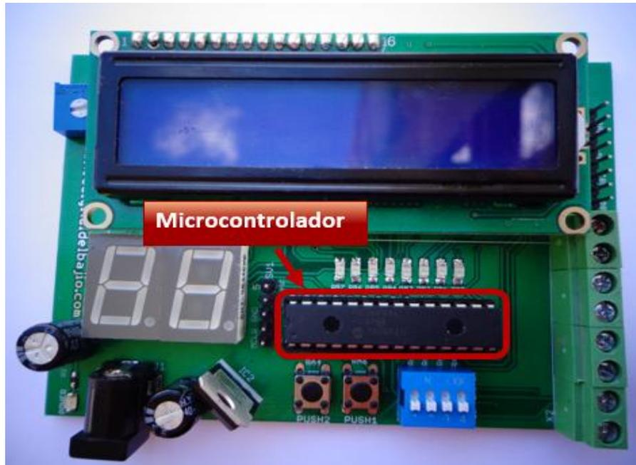
Figura 2.1 Microcontrolador PIC16F886
