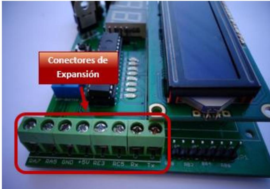
Figura 2.21 Conexión de la LCD al PIC16F886
