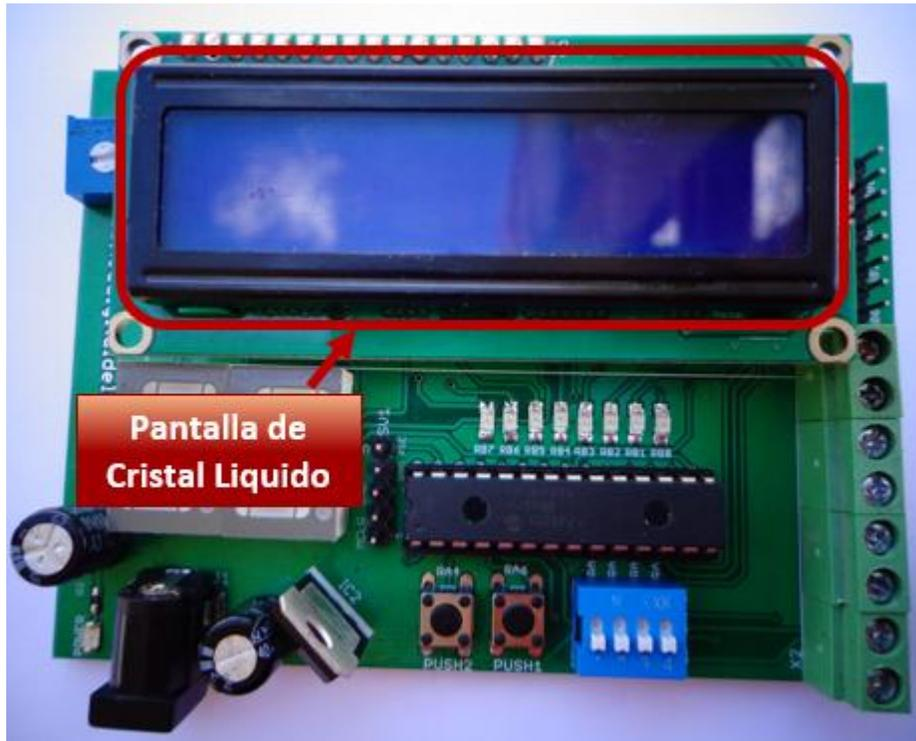
La LCD es de 2 \* 16 caracteres, esto es, puede mostrar en dos renglones hasta 16 caracteres, la LCD muestra el texto en color blanco sobre un fondo azul, este tipo de displays se pueden conectar al microcontrolador de dos formas con una interfaz de datos de 8 bits, lo que implica usar 8 pines del microcontrolador para los datos o la interfaz de 4 bits, con obviamente 4 conexiones de datos al microcontrolador.
