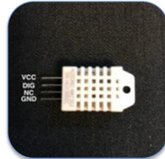
Connecting the DHT22 Sensor
